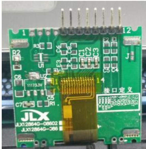
第四步：在单片机对应处焊接屏幕的 IC 座。如图
