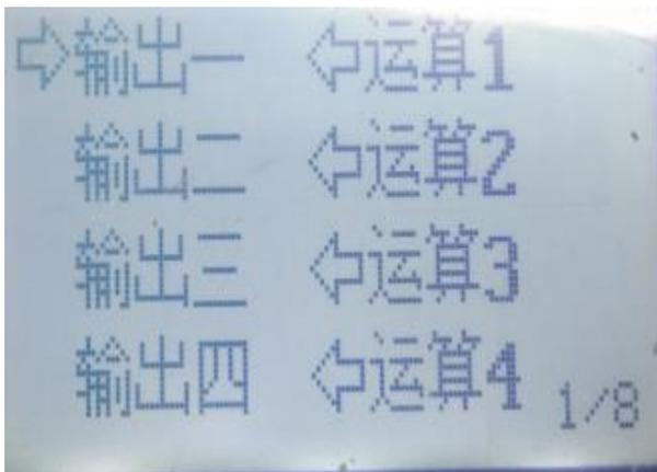
输出映射状态。可以手工选择输出对应通道。
