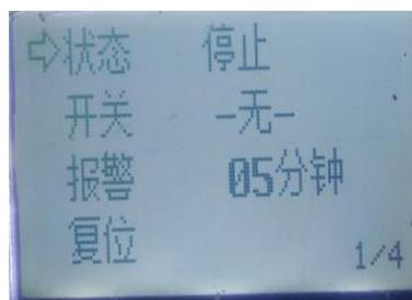
默认状态是停止的。需要手动打开。<定时器>每台飞机的具体型号和参数是不同的导致飞行时间不尽相同。定时器功能可以在你的飞机燃油或电池消耗完之前。用警示声提醒你吧飞机安全降落至地面。
