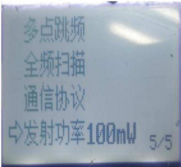
无线设置→发射功率→确认。
