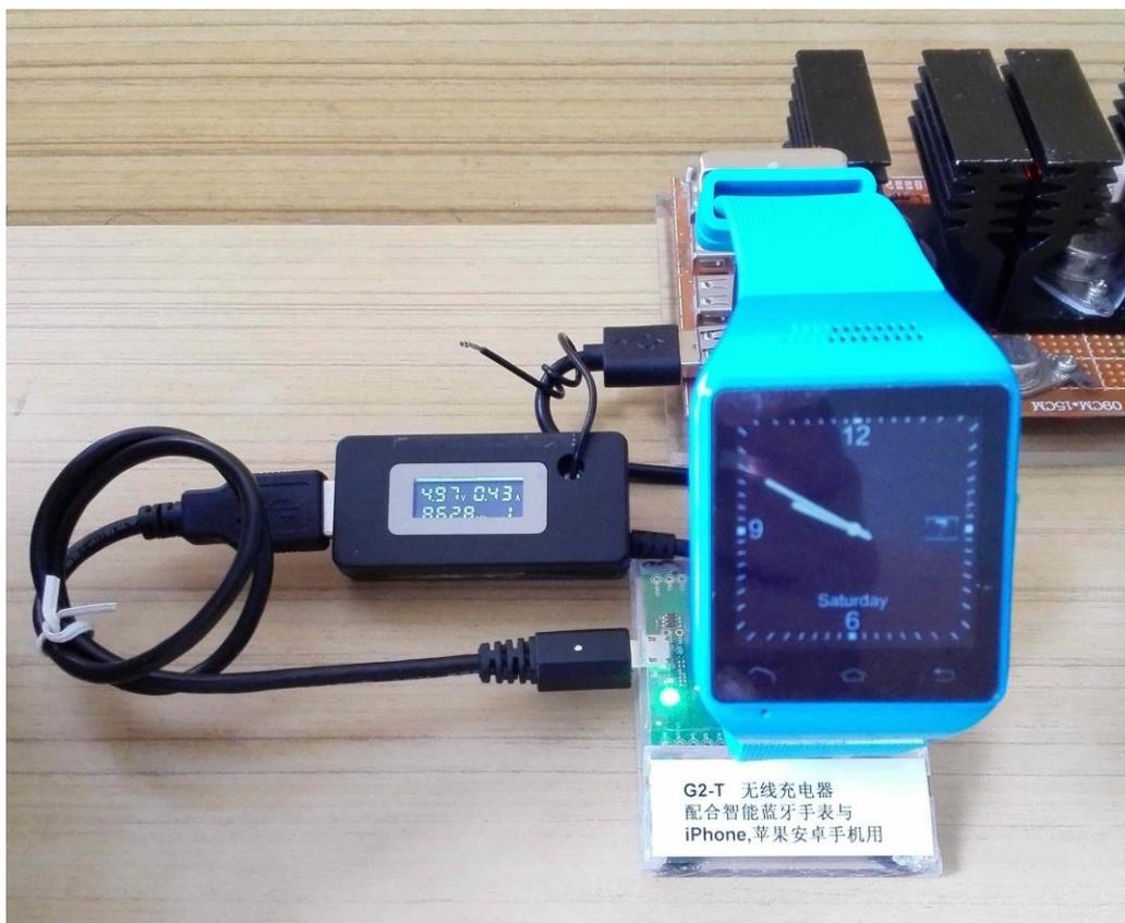
Fig. 10 智能手表 Q3 放在发射器上充电
